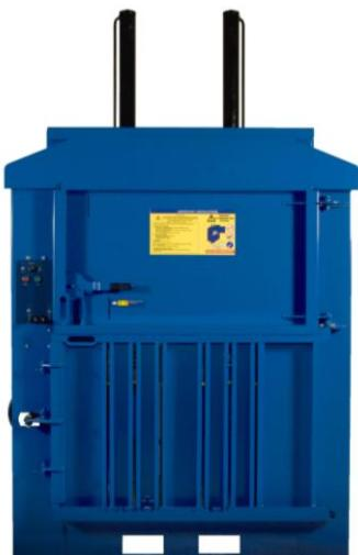
**VP-250:** Peso de las balas producidas hasta 250 Kg. Produce fardos del tamaño de un europalet, lo que facilita su manipulación. Ganchos de retención para evitar la expulsión de material. Expulsor de balas completamente automático para una expulsión fácil y segura. Ideal para utilizar con volúmenes medios y grandes de material.
